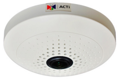
B54 CI215ACT12-10 5 Megapíxeles 1080 | 7FPS Lente de 1.19mm | Interior WDR Básico / DNR / SD / PoE / DIDO
