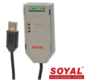
SOYAL AR-321CM CC074SOY08 CONVERTIDOR USB a RS-485 Necesario para configurar lectores RS-485 SOYAL.
