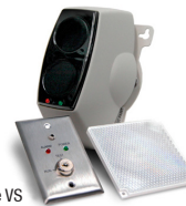
EC-100R IP020EDW09-14 Detector de Humo Refleactivo FotoBeam • Cobertura de 15x100m • Fácil alineación • Consumo de corriente en alarma de 8mA • Alimentación 24VAC
